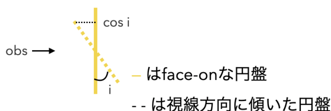
図 A.3 視線方向に対して傾いた円盤の射影の概念図。黄色の実線は face-on の円盤、破線は視線方向に傾斜角 i だけ傾いた円盤を表す。
