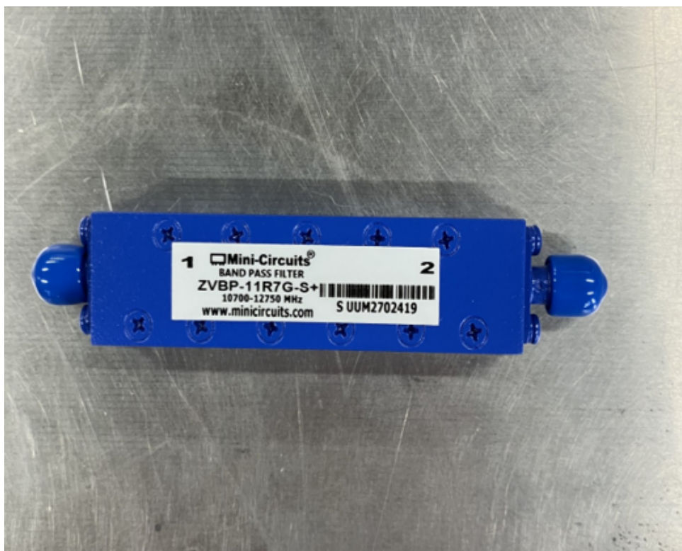
図 5.8: 10.7–12.75 GHz BPF 型番 [Mini-circuits ZVBP-11R7G-S+]
