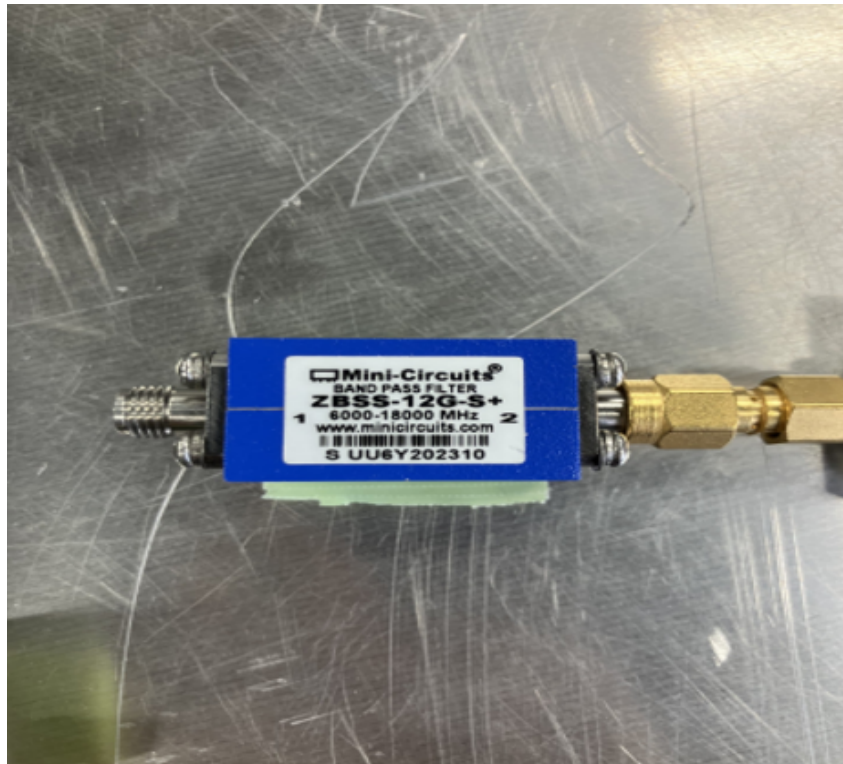
図 5.10: 4-18 GHz BPF 型番 [Mini-circuits ZBSS-12G-s+]
