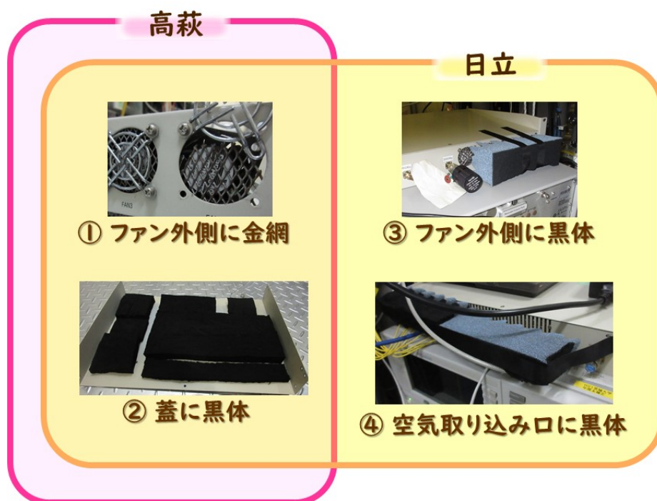
図: A.41 サンプラーに施した対策
