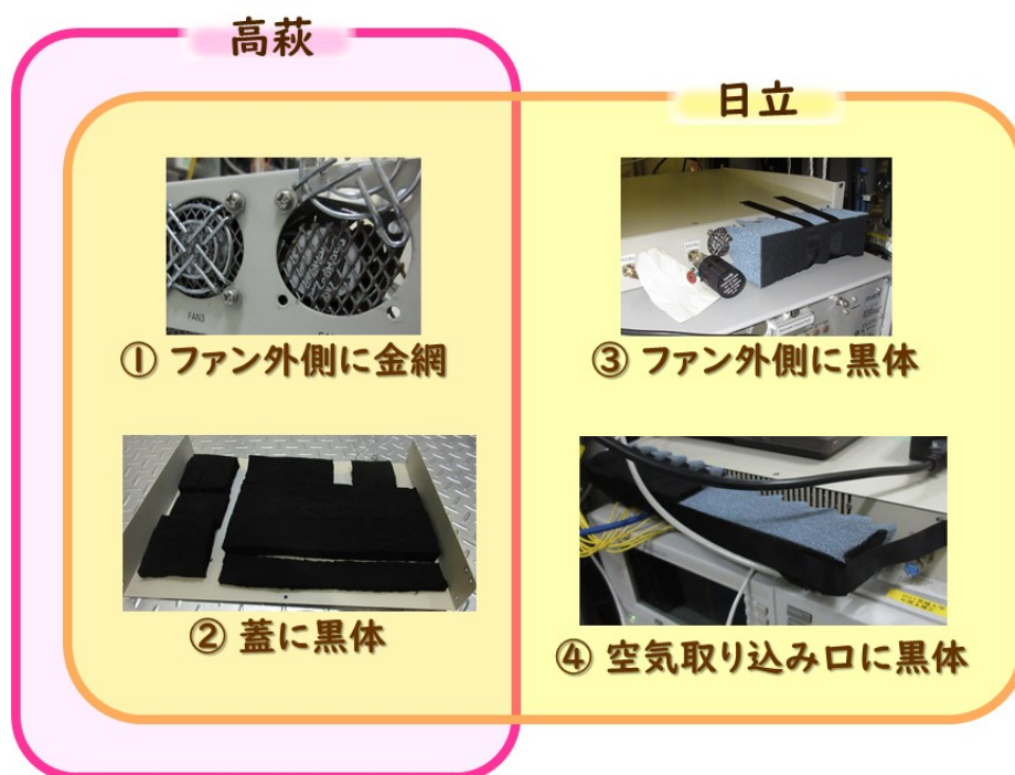
図 4.21: サンプラーに施した対策
