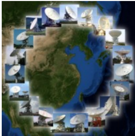
図 3.2: 東アジア VLBI 観測網 (EAVN) : 東アジア各国の望遠鏡を連携させて、最大基線 6000km の世界最大級の電波望遠鏡観測網をつくる計画。現在は既に日本、韓国 (KVN)、中国 (上海局) の 3 カ国間で観測が開始されている。(図は国立天文台水沢 Web から引用)
