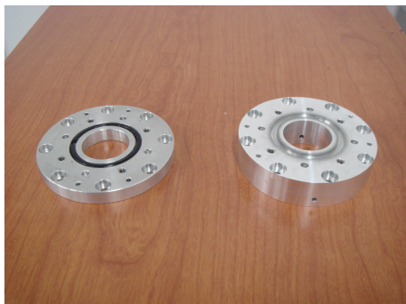
Fig. 4.6: 左：従来のフランジ、右：新たに開発されたフランジ
