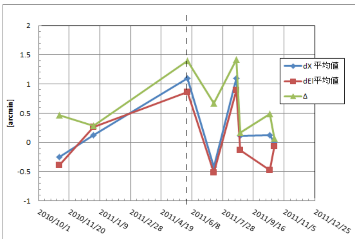
図 4.20: 指向誤差の平均値の推移 破線の左側が地震前、右側が地震後である。
