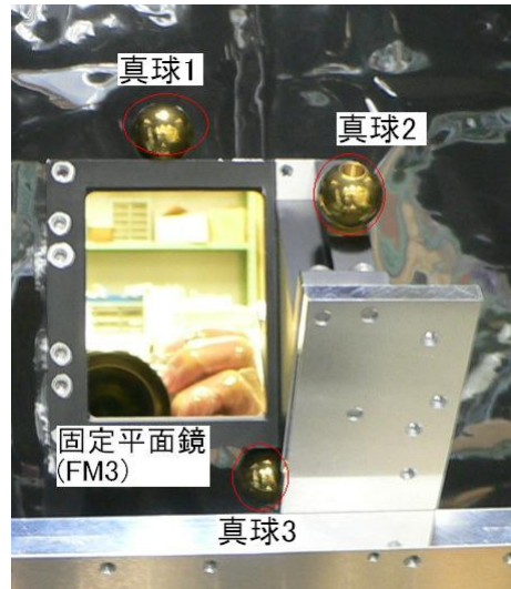
図 4.17: 固定平面鏡 (FM3) の真球位置と番号
