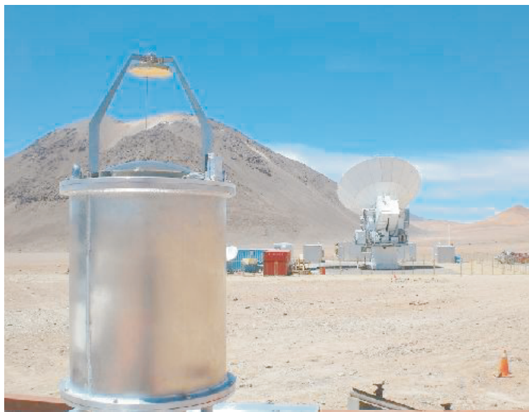
図 2.1: APEXサイトに設置された雲モニタ。後方の望遠鏡はAPEX望遠鏡。
