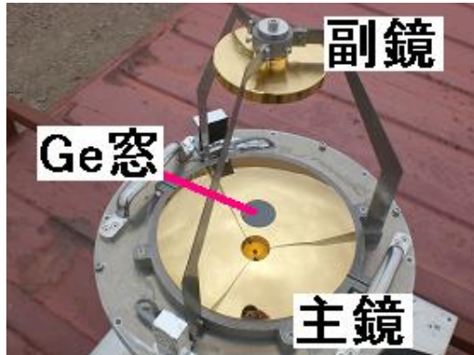
図 2.2: 光学系。主鏡・副鏡ともに凸面鏡で赤外線反射率の高い金でコーティングされている。
